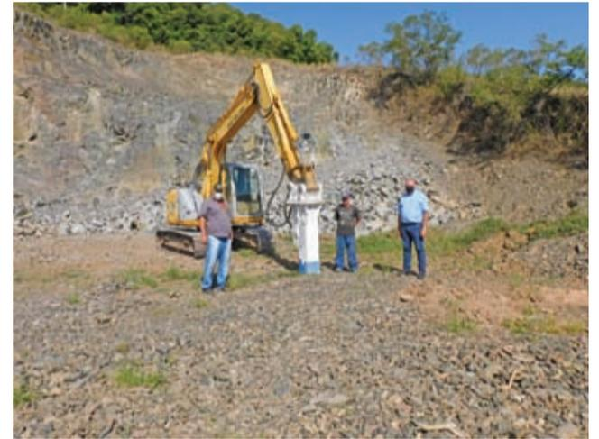
&gt;&gt; Aquisição de um novo rompedor, equipamento que é acoplado à escavadeira hidráulica, sendo utilizado na extração de basalto para a produção de brita
