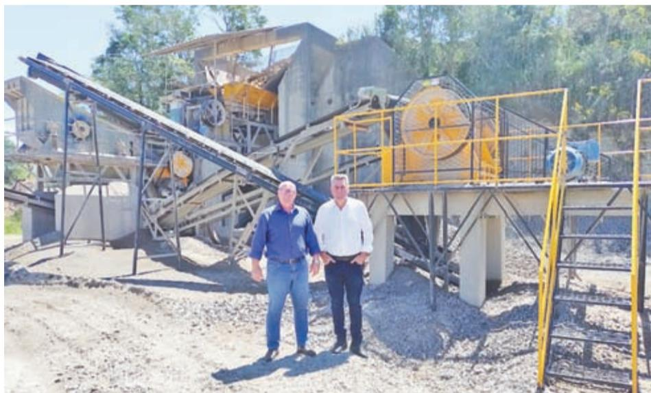
250m<sup>3</sup> por dia, entre pó e brita 1 e 2. Foram adquiridos um britador de 50 CV no valor de R\$ 361 mil, uma correia de 12,5 m de extensão por R\$ 62 mil, um painel elétrico de R\$ 38 mil e realizada a manutenção do motor atual custando R\$ 9 mil, totalizando R\$ 470 mil.
