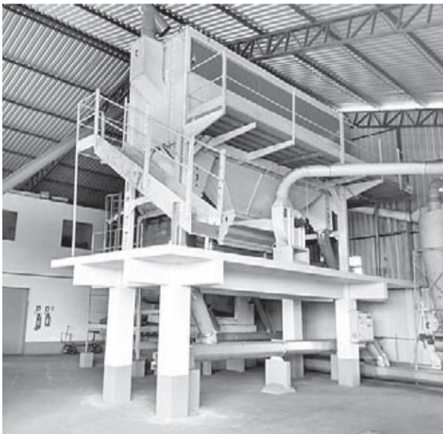
>> Máquina rotativa amplia capacidade de limpeza de grãos
